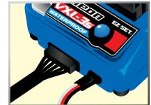
Des Weiteren verfügt der VXL-3s über eine Sensorphasen-Erkennung. Wenn ein bürstenloser Motor mit Sensoren angeschlossen ist, überprüft der VXL-3s, ob er richtig verkabelt ist. Falls die Motorphasen-Verkabelung nicht richtig ist, gibt der VXL-3s keine Energie an den Motor ab, bis dieser richtig verkabelt ist.
