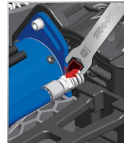
Platzieren Sie das Modell auf einem Untergrund mit hoher Traktion, z. B. einem Teppich. Stellen Sie die Rutschkupplung so ein, dass Sie sie ungefähr 60 cm (zwei Fuß) hören, wenn Sie aus dem Stand voll beschleunigen. (Lesen Sie mehr über die Rutschkupplung in der Leiste an der Seite.)
