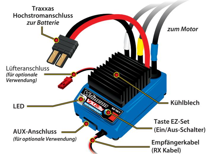
\*\* Zusätzlicher Sensoranschluss zur Verwendung mit der TQi Dockingstation (mehr Informationen auf Traxxas.com und in den mitgelieferten Materialien)
